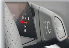
Fahrstufenschalter neben Lenkrad
