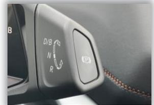
**Taste Parkbremse** oberhalb Fahrstufenschalter
