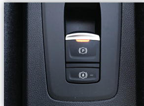
(4) Die Parkbremse löst sich beim Losfahren von selbst.
