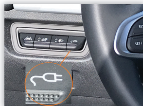
(1) Taste zum Entriegeln des Ladekabels am Auto
